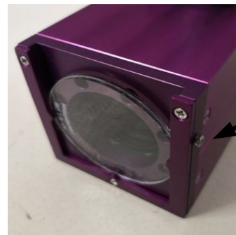
Schraube zur Sicherung des Schutzglases
