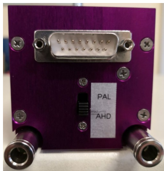
Anschlüsse für Kühlung Schlauch 6mm AD
